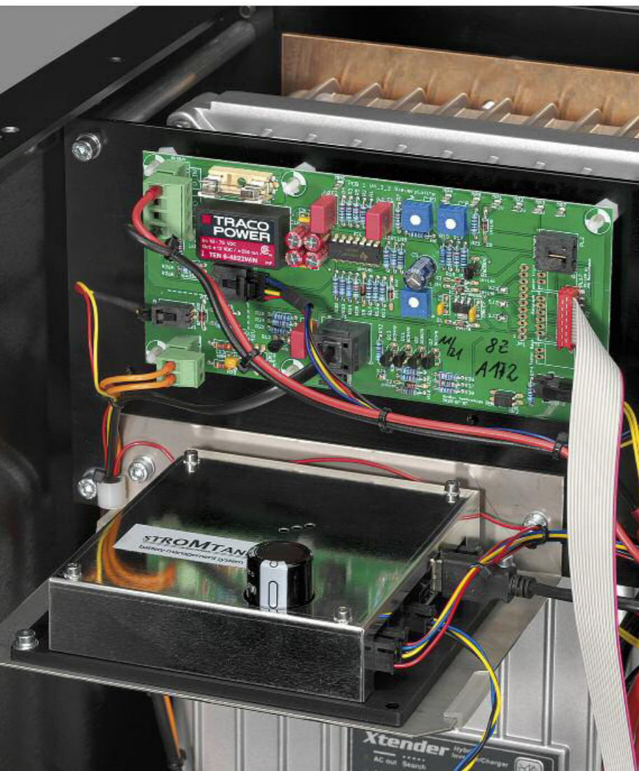
Oben: Auf den 8 Batterieblöcken sind die dazugehörigen regionalen Controller-Platinen gut zu erkennen. Sie melden Ladezustand, Temperatur, Spannung und Strom an den Hauptcontroller. Die Batterien durchlaufen bei Stromtank einen einwöchigen Dauerladetest und werden anschließend nach ihren Eigenschaften gematcht
